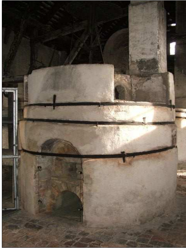
Abb. 17 Ein Glasofen des optischen Instituts. Vergleichbare Öfen wird es auch in der Glashütte für Gebrauchsglas gegeben haben.
