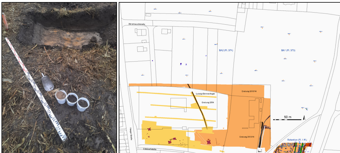
Abb. 4 Links: Probennahme durch Herrn Zaegel von Fa. Sakosta. Rechts: Verteilung der Schürfe für Fa. Sakosta (und Fa. MuN) in den Baufeldern BA1 und BA2.
