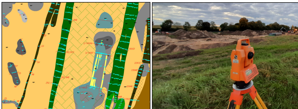
Abb. 3 Ausschnitt des CAD-Plans, Totalstation für die Vermessung.
