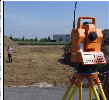
Abb. 11 Links: Fest- und Anschlusspunkte der Grabung. Rechts: Aufmaß des Planums mittels Totalstation.
